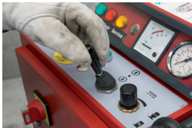
Agire sulla valvola di controllo avanzamento (DS WS10-E).
